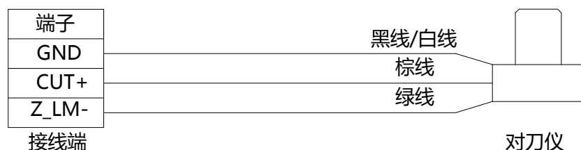
图 2-7 对刀仪接线图
